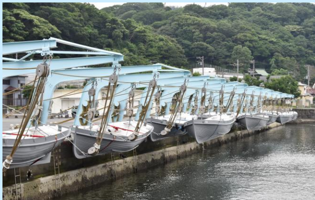
ダビットクレーンに固定されたカッター
